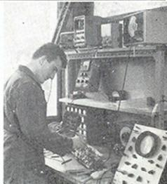
Sur ce poste de câblage sont montés des circuits imprimés qui équiperont ensuite les préamplificateurs.
